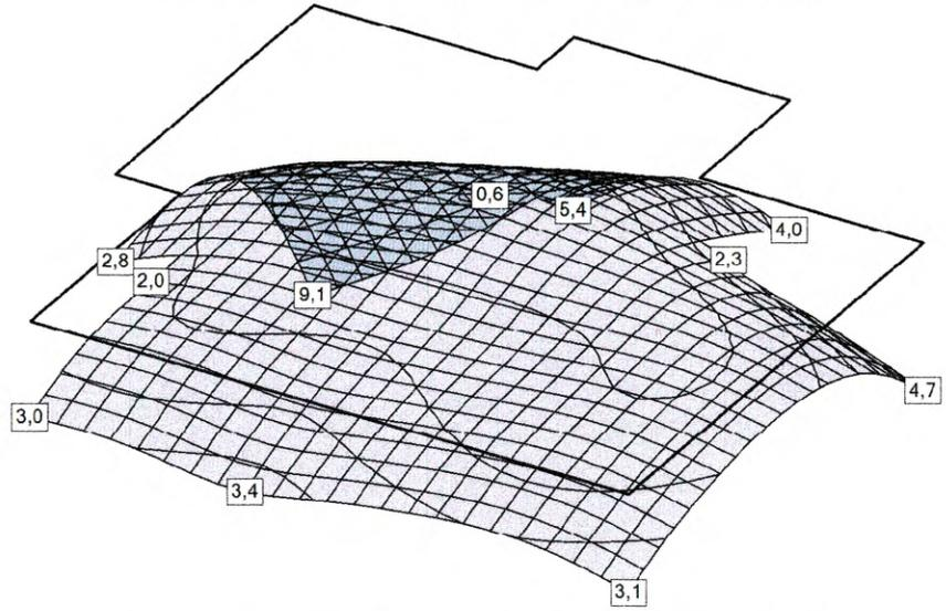
Maximalwerte - Verformung im Zustand I (GZG): wz [mm]
